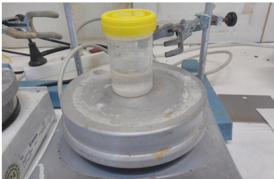
Figura 8. Proceso de preparación de la disolución con sol-gel de \text{SiO}_2 + Ag.
